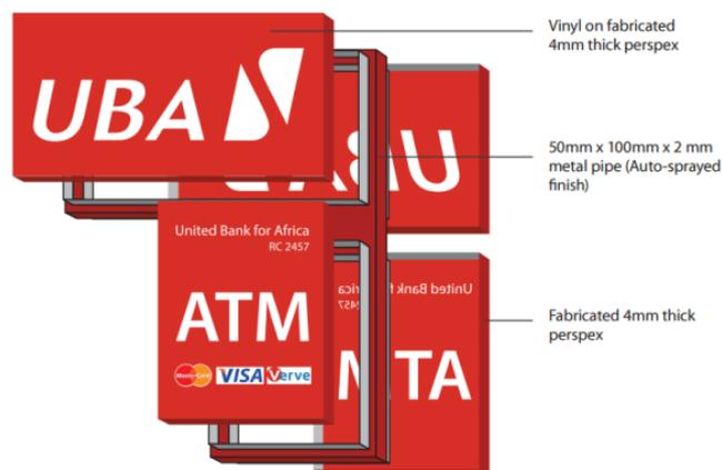
**NB : structure métallique entourant une tôle en Alucobond avec découpe, encastré en plexi et circuit électrique.**
